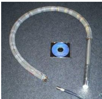
Bild: Inspektionssystem (Kamera)
